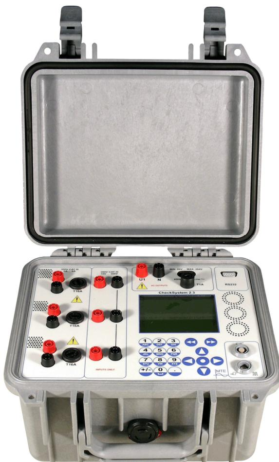
Портативная тестовая система CheckSystem 2.3 состоит из интегрированного трехфазного источника тока и трехфазного электронного образцового счетчика класса точности 0.2. Характерными особенностями CheckSystem 2.3 являются широкий диапазон измерений, высокая точность и высокая устойчивость к нежелательным внешним воздействиям.
